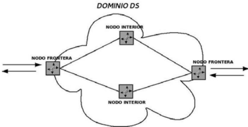
Los nodos frontera permiten la interconexión de varios dominios DS o con dominios que no soportan los Servicios Diferenciados. Deben ser capaces de aplicar un PHB apropiado a los paquetes basados en el campo DSCP. Además, puede ser necesario que apliquen mecanismo de adaptación del tráfico, definidas mediante un TCA (Traffic Conditioning Agreement), entre su dominio DS y los dominios DS conectados a él.
