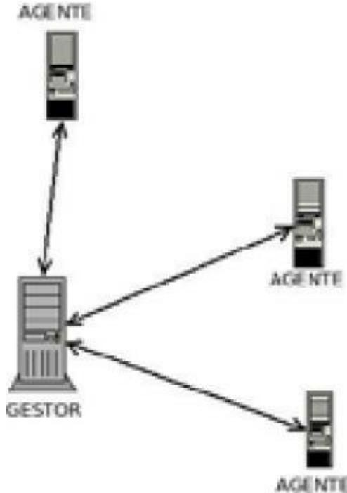
–Capa de protocolo de transporte: esta capa proporciona un camino de comunicación entre el cliente y el servidor. Netconf especifica los requisitos que debe cumplir, pero no incluye un mecanismo propio, para realizar esta tarea se utilizan protocolos como SSH o SSL.
