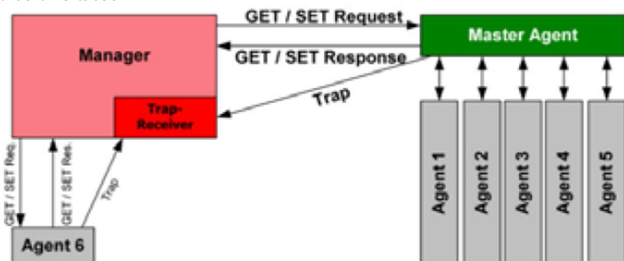
SNMP realiza intercambio de información de forma estructurada, este intercambio es realizado a través de una serie de mensajes, que tienen una estructura compuesta por tres campos:
