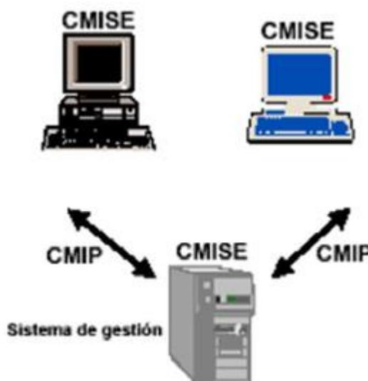
El intercambio de información se realiza mediante CMISE puede ser especificado en dos partes. Por una parte, tenemos el acceso de usuario mediante una interfaz mediante CMIS. El protocolo que se utiliza para la transmisión de la información se denomina CMIP, donde se especifica el formato y los procedimientos asociados.
